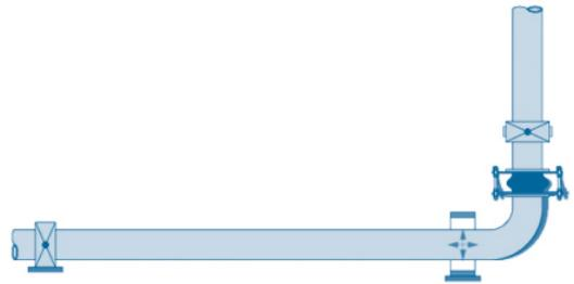
5. Компенсатор следует устанавливать непосредственно за неподвижной опорой.
