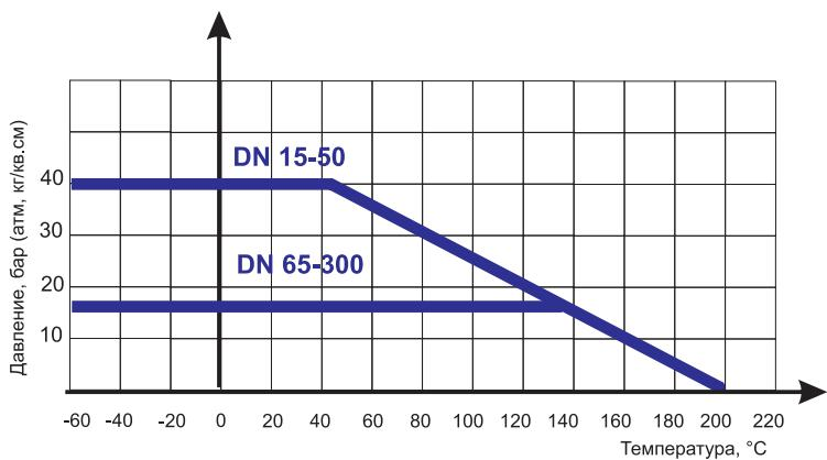
Диаграмма определяет рабочую область для шарового крана фланцевого ABRA-BV41 в координатах Давление (в барах приборного) / Температура (°C).
